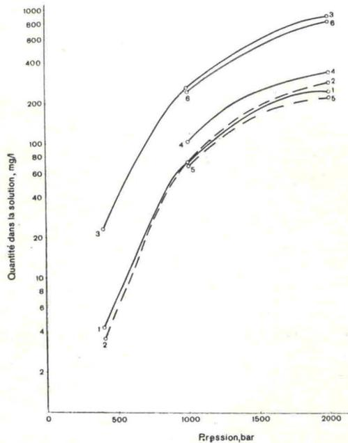
FIG. 2. — Transition des minéraux constituants des roches en solution sous l'action de l'eau chauffée isothermiquement sur l'albite et le microcline à 500° C.
